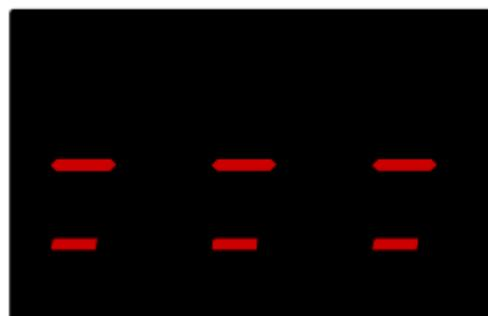
По завершении тестирования звучат два коротких звуковых сигнала, а изделие переходит к обработке результатов измерения, в это время на дисплее крайние боковые, верхние и нижние сегменты индикатора высвечиваются поочередно в режиме «бегущие огни».
