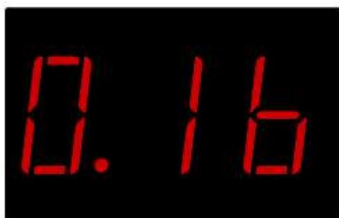
Внимание: Прибор ожидает выдоха в течение 20 секунд. Если выдох в течение этого времени не производился, то прибор автоматически отключается. При ожидании выдоха, расходуется энергия источников питания. Поэтому, не рекомендуется оставлять прибор включенным продолжительное время.
