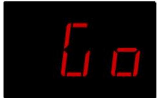
5. Для проведения теста на наличие алкоголя в крови, обследуемый должен произвести глубокий вдох, а затем, не прерываясь, выдохнуть воздух из легких через мундштук в реакционную камеру изделия. Выдох должен быть достаточной силы, при правильном выдохе, звучит непрерывный звуковой сигнал в течение примерно 8-10 секунд, а на дисплее высвечиваются поочередно в режиме «бегущие огни» попарно нижние и средние сегменты разрядов индикатора.
