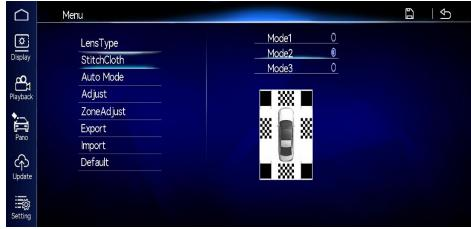
Калибровка 4,4 м. (Передняя и задняя с левым и правым шахматным рисунком, длина передней и задней калибровочной ткани 4,4 метра; калибровка автоматическая).
