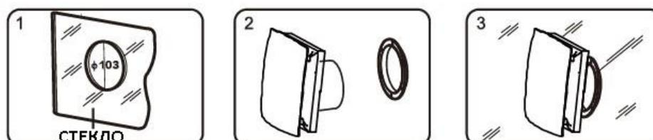
1. Вырежьте отверстие диаметром 103, 120 или 150 мм в стекле.
