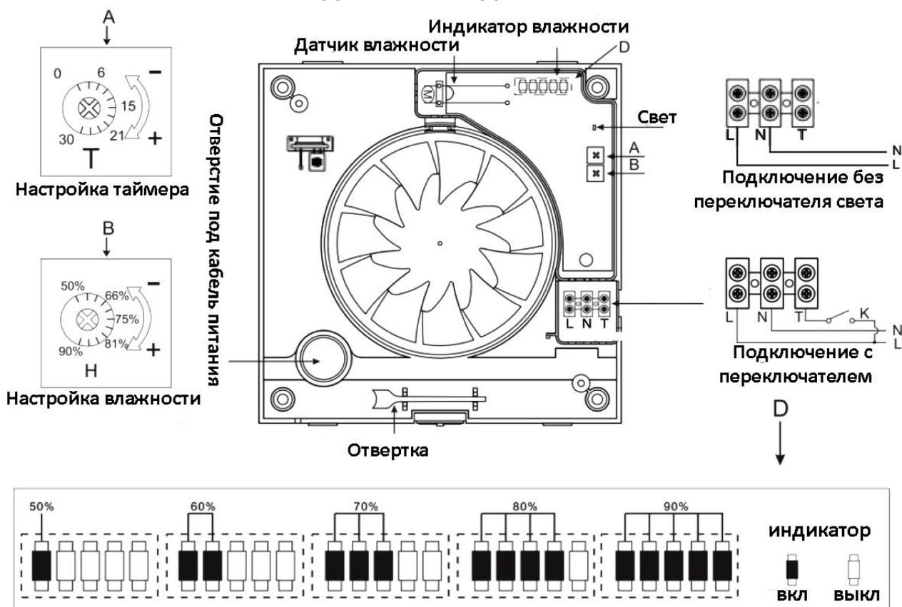
Настройка таймера задержки выключения регулируется от 1 до 30 минут, а уровень влажности регулируется от 50% до 90%. Таймер и уровень влажности можно регулировать, поворачивая ручку управления по часовой стрелке для увеличения и против часовой стрелки для уменьшения показателя. Световой
