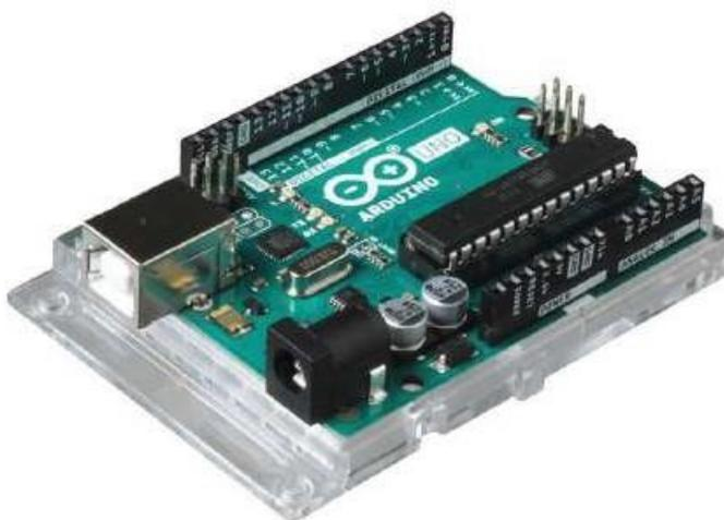
Контроллер / плата / микропроцессор Arduino UNO R3 считывает показания датчиков, управляет исполнительными механизмами (актуаторами) и выводит результат для пользователей.
