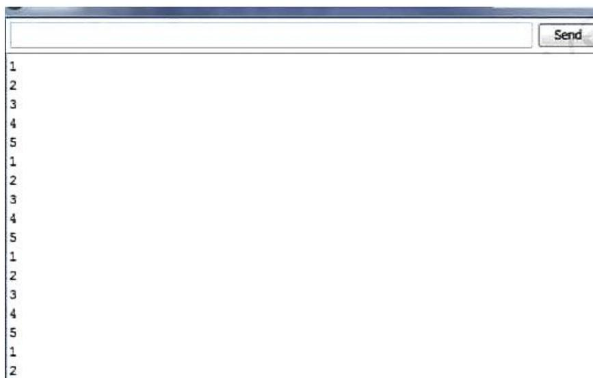
Чтобы передать данные в Serial Monitor, сначала нужно открыть соединение с помощью **Serial.begin(speed\_in\_bauds)**, а потом воспользоваться функциями **Serial.print()** или **Serial.write()** для отправки данных. Чтобы считать данные, используйте функцию **Serial.read()**.
