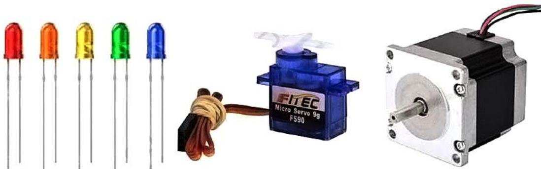
Исполнительные механизмы или актуаторы воздействуют на окружающую среду. Различные моторы, насосы, светодиоды, воздушные винты и так далее.
